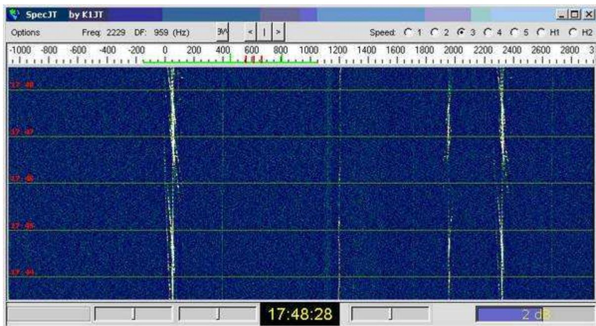
**Bild 2: Anzeige des über Tropo empfangenen Graves-Radars mit WSJT**
